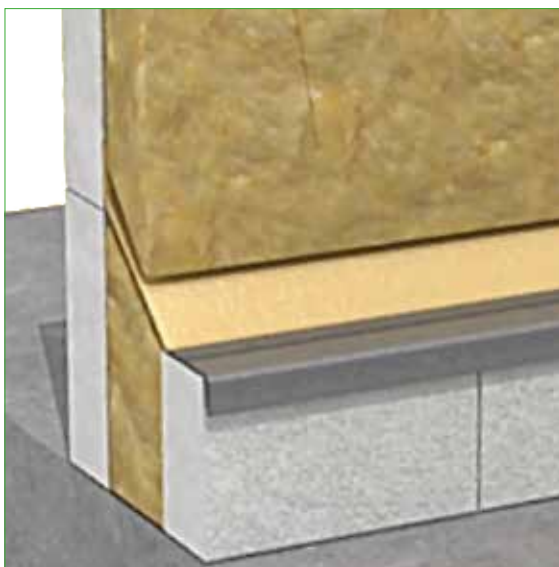
Eindsituatie na aanbrengen isolatie.
